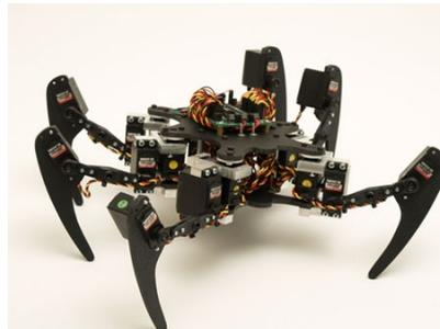
Figura 7.2: Robot hexápodo Phoenix
