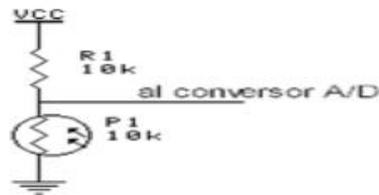
Figura 5.2: Diagrama fotoresistencia
